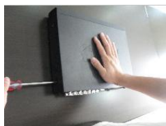
6. Завинтите корпус болтами
