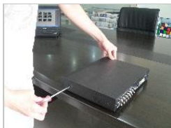
1. Снимите болты на обеих сторонах
