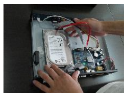
3. Соедините жёсткий диск с платой
