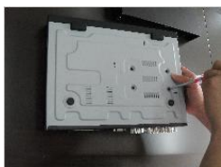
4. Зафиксируйте болтами жёсткий диск
