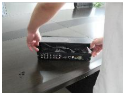
2. Снимите верхнюю крышку
